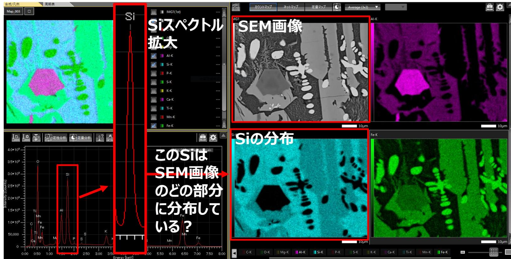
検出されたSi (赤枠) がSEM画像のどの部分に分布しているのかを水色のコントラストで表記
